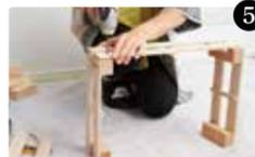
下穴と角材をビスで固定し、箱形に組み立てる。
